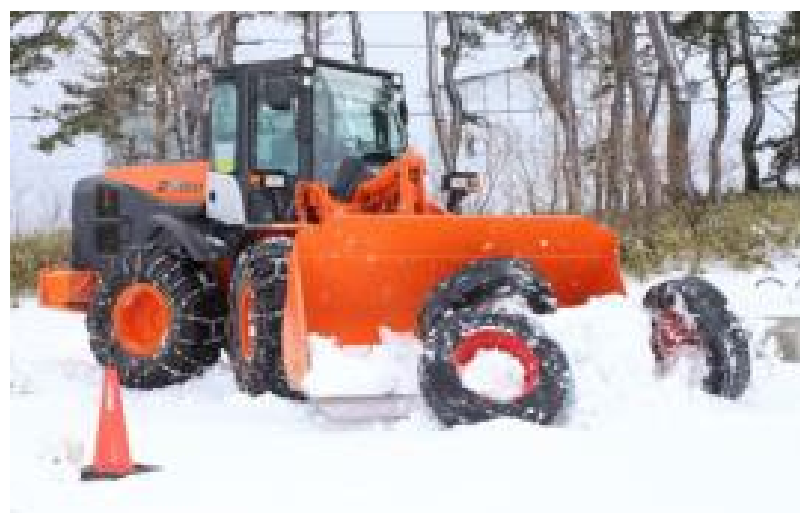
ホイールローダによる アクセスルートの整地（除雪）
